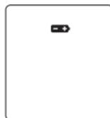
As pilhas estão quase descarregadas. Substituir as pilhas imediatamente. Se o símbolo reaparecer depois de substituir as pilhas, voltar a retirar as pilhas, premir e manter o botão ligar/desligar/configurar premido durante, pelo menos, 2 segundos e introduzir novamente as pilhas.
