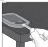
Introduzir a extremidade metálica da tira-teste no aparelho de medição. Colocar o aparelho de medição numa superfície plana.
