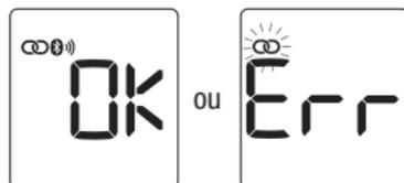
A indicação **OK** é apresentada se o emparelhamento for bem sucedido. A indicação **Err** é apresentada se o emparelhamento não for bem sucedido.
