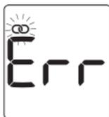
Não foi possível emparelhar o aparelho de medição com um dispositivo móvel.
