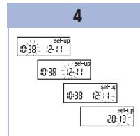
Επαναλάβετε το βήμα 3 για να ρυθμίσετε τα λεπτά, την ημέρα, το μήνα και το έτος. Εάν θέλετε να προχωρήσετε στη ρύθμιση και άλλων παραμέτρων, πατήστε και αφήστε το κουμπί ①. Εάν θέλετε να βγείτε από τη λειτουργία ρυθμίσεων, πατήστε και **κρατήστε** πατημένο το κουμπί ① μέχρι να δείτε το σύμβολο δοκιμαστικής ταινίας να αναβοσβήνει στην οθόνη.
