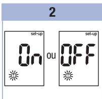
Premir e soltar **①** várias vezes, até aparecer no visor **set-up** (configuração), **OFF** (desligado) e **①** a piscar.
