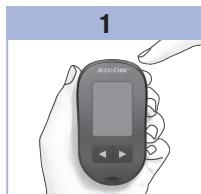
Pulse y suelte ① para encender el medidor. El símbolo de la tira reactiva parpadeando aparece en la pantalla. Pulse y **mantenga pulsada** ① hasta que aparezca **set-up** en la pantalla.
