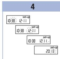
Pulse y suelte ① (tecla On/Off/Set) para encender el medidor.
