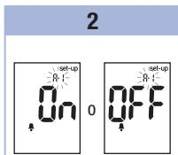
Pulse y suelte ① repetidamente hasta que aparezcan el símbolo de la campana, **OFF**, **set-up** y **A-1** parpadeando en la pantalla.
