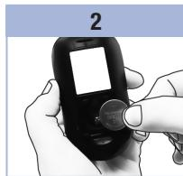
Extraiga la pila usada. Inserte la pila nueva con el **símbolo (+) mirando hacia arriba**.
