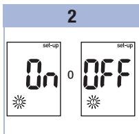
Pulse y suelte ① repetidamente hasta que aparezcan **set-up**, **OFF** y ① parpadeando en la pantalla.
