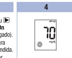
Premir e soltar **◀** ou **▶** para alternar entre **On** (ligado) e **OFF** (desligado).
