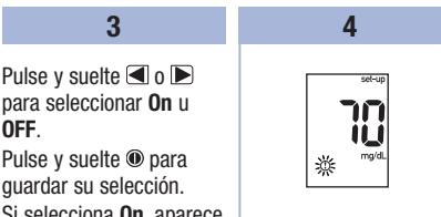
Pulse y suelte ② o ③ para seleccionar **On** u **OFF**. Pulse y suelte ④ para guardar su selección. Si selecciona **On**, aparece **set-up** y ④ parpadea.
