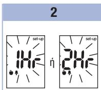
Πατήστε και αφήστε το κουμπί ③ επανειλημμένα μέχρι να εμφανιστεί στην οθόνη η ένδειξη **set-up** και η ένδειξη **1Hr** ή **2Hr** αναβοσθήνει στην οθόνη.
