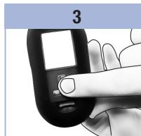
Abrir a tampa do compartimento da pilha, na parte de trás do aparelho de medição empurrando a patilha na direção da seta e puxando a tampa para cima.
