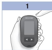
Πατήστε και αφήστε το κουμπί ① για να θέσετε το μετρητή σε λειτουργία. Στην οθόνη αναβοσβήνει το σύμβολο μιας δοκιμαστικής ταινίας.
