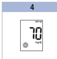
Pulse y suelte ② o ③ para ajustar el nivel. Pulse y suelte ④ para guardar el nivel. Para salir, pulse y **mantenga pulsada** ④ hasta que aparezca el símbolo de la tira reactiva parpadeando en la pantalla. Ha concluido el modo de ajuste.
