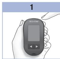
Πατήστε και αφήστε το κουμπί ① για να θέσετε το μετρητή σε λειτουργία. Στην οθόνη αναβοσβήνει το σύμβολο μιας δοκιμαστικής ταινίας.
