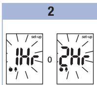
Pulse y suelte ② repetidamente hasta que aparezcan **set-up** y **1Hr** o **2Hr** parpadeando en la pantalla.
