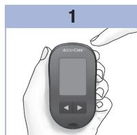
Πατήστε και αφήστε το κουμπί ① για να θέσετε το μετρητή σε λειτουργία. Στην οθόνη αναβοσθήνει το σύμβολο μιας δοκιμαστικής ταινίας.
