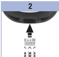
Inserte la tira reactiva en el medidor según la dirección de las flechas. Coloque el medidor en una superficie plana.
