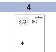
Pulse y suelte ② o ③ para ajustar la hora. Pulse y suelte ① para guardar la hora. Los minutos parpadean.
