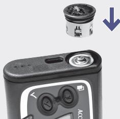
Coloque a tampa sobre o terminal positivo e empurre ligeiramente a bateria para dentro, rodando ao mesmo tempo a tampa no sentido dos ponteiros do relógio, para ficar parcialmente apertada.
