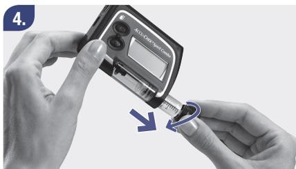
Se necessário, retire o cartucho. Desaperte cuidadosamente. Não puxe o cartucho para fora sem estar completamente desapertado.
