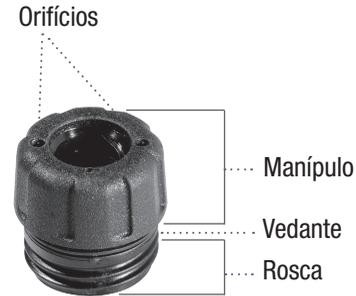
O adaptador liga o cartucho ao conjunto de infusão e mantém hermético o compartimento do cartucho, com 2 vedantes, um no interior e outro no exterior do adaptador. Mantém o cartucho fixo e evita a entrada de bolhas de ar. Os 2 orifícios pequenos no adaptador permitem igualar a pressão do ar dentro e fora do compartimento do cartucho. O adaptador não funciona correctamente se os orifícios estiverem bloqueados ou sujos ou se faltarem os vedantes.
