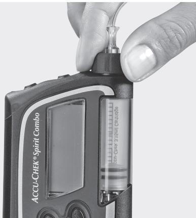
Confirme que a bomba está correctamente ligada (incluindo cartucho, adaptador e conjunto de infusão) e programada com as suas definições pessoais.
