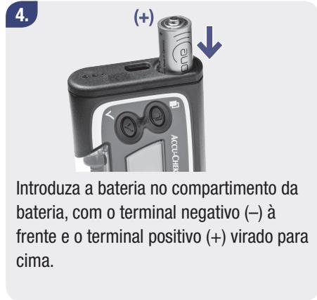
Introduza a bateria no compartimento da bateria, com o terminal negativo (-) à frente e o terminal positivo (+) virado para cima.
