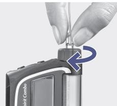
Enrosque o conjunto de infusão Accu-Chek no adaptador, rodando-o no sentido dos ponteiros do relógio. Cuidadosamente, aperte o conector luer-lock manualmente.
