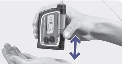
Para garantir a eliminação de todas as bolhas de ar, segure a bomba na posição vertical e, suavemente, bata a parte inferior contra a palma da sua mão.
