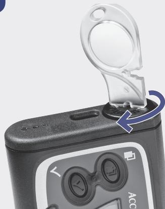
Utilize a chave da bateria para completar o aperto da tampa da bateria. Para confirmar se a tampa da bateria está correctamente apertada, verificar se está alinhada com o corpo da bomba. Não aperte demais.
